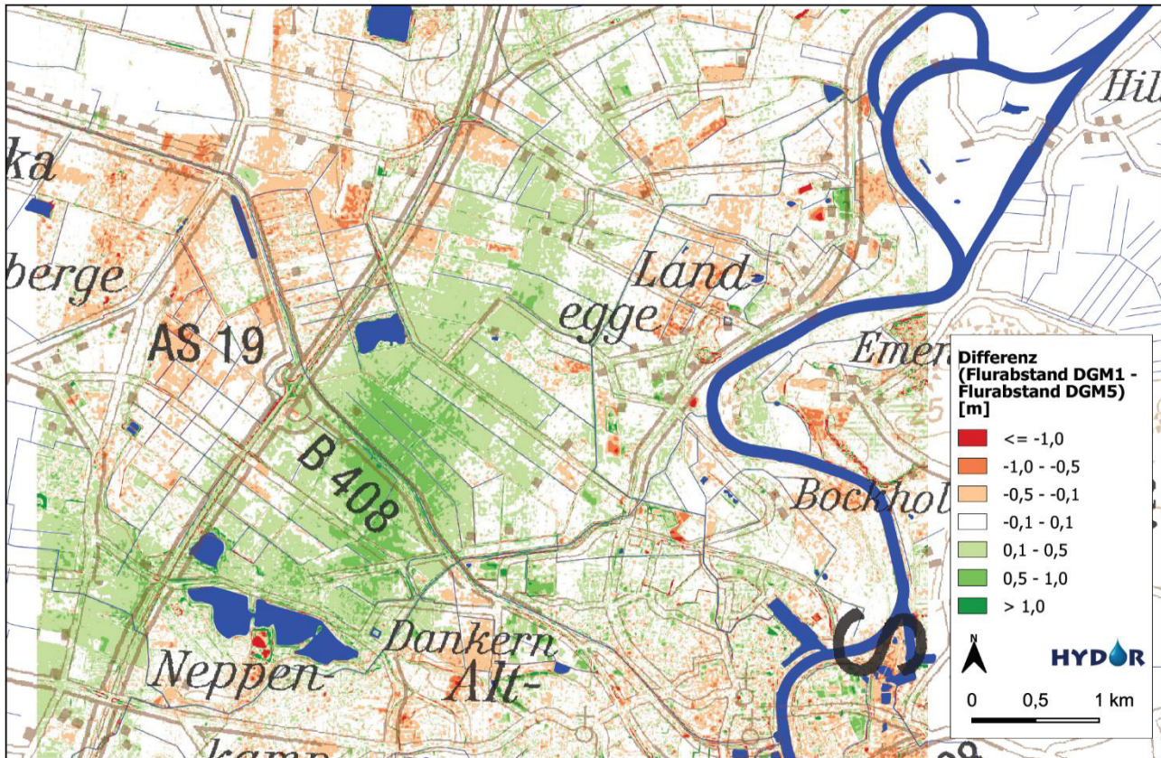
Abbildung 24: Differenz der berechneten Flurabstände basierend auf dem DGM1 und dem DGM5 für ein Teilgebiet
